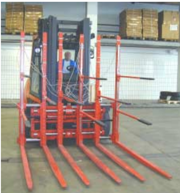
Abbildung 13: Antennenkonstruktion zur Pulkerfassung
