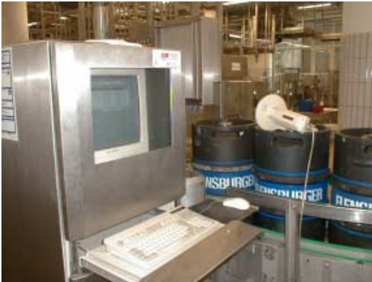
Abbildung 11: Terminal in der Abfülllinie für den Zugriff auf die Datenbank
