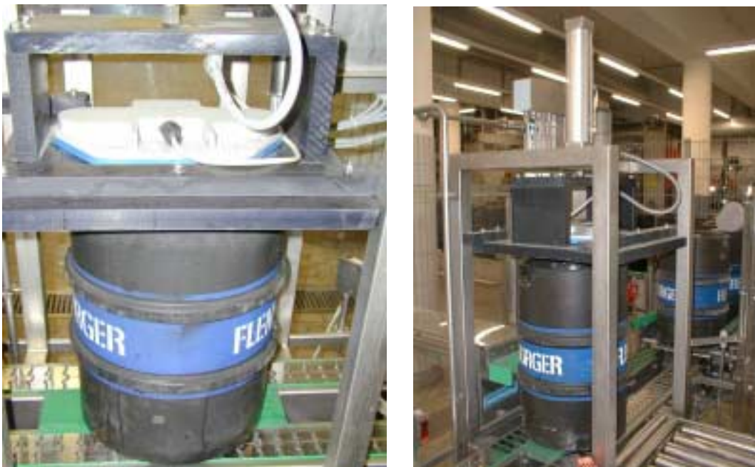
Abbildung 10: Stationäre Antenne in der Abfülllinie am Beispiel der Flensburger Brauerei
