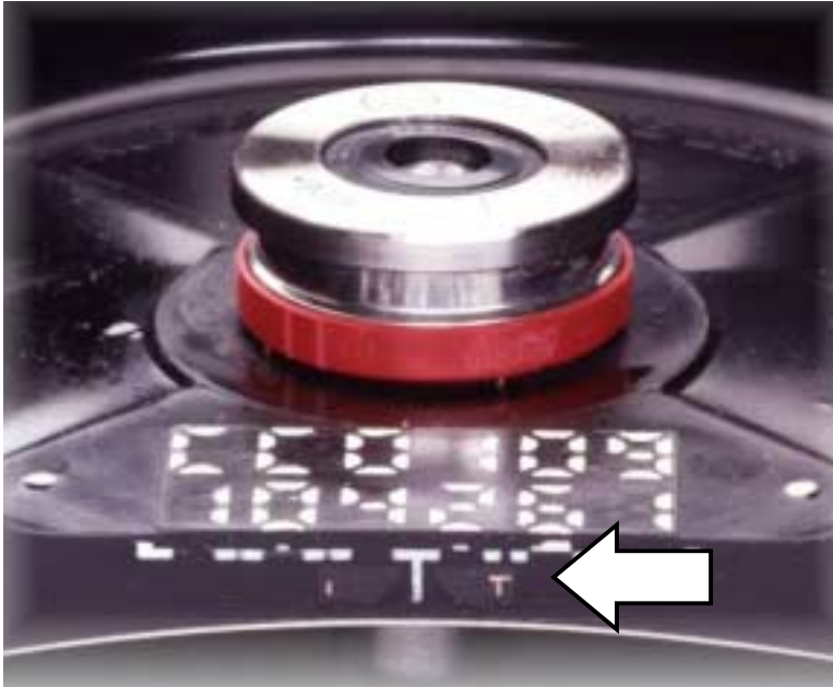
Abbildung 8: Sitz des Transponders unterhalb der Klarschriftcodierung datixPLUS
