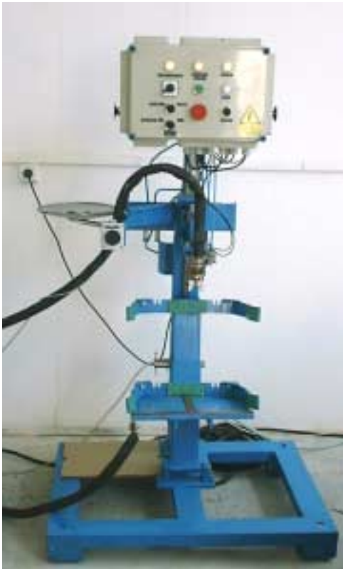
Abbildung 4: Schweißapparat für Transponder (ID 700)
